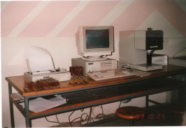
Şekil 3.1. Spektralfotometre (Datacolor Texflash DC 3881 tipi bilgisayarlı renk ölçüm cihazı)
