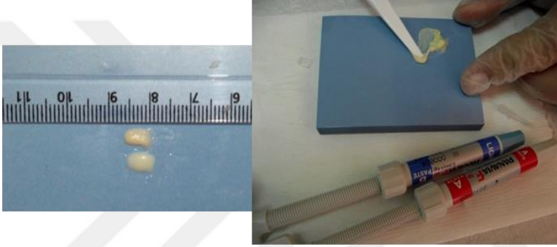
Şekil 2.23. Panavia F Paste A” ve “Panavia F Paste B” 1:1 oranında karıştırılması
