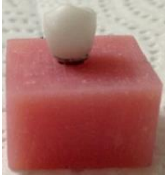
Şekil 2.27. Titanyum destek üzerine simante edilmiş monolitik zirkonya kron
