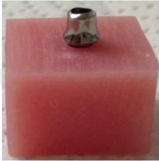
Şekil 2.14. Üretilen titanyum destek
