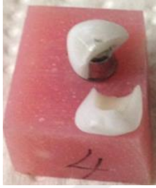
Şekil 3.4. Titanyum destek üzerindeki monolitik zirkonya kronun tek parçalı kırığı
