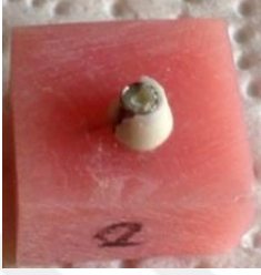
Şekil 3.8. Ti-Base zirkonya destek kırığı
