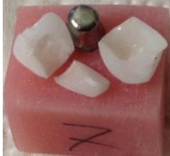
Şekil 3.5. Titanyum destek üzerindeki monolitik zirkonya kronun çok parçalı kırığı
