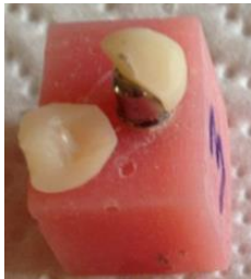
Şekil 3.6. Titanyum destek üzerindeki Lava Ultimate kronun tek parçalı kırığı
