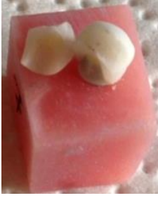
Şekil 3.9. Ti-Base zirkonya destek üzerindeki monolitik zirkonya kronun tek parçalı kırığı
