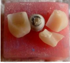
Şekil 3.12. Ti-Base zirkonya destek üzerindeki Lava Ultimate kronun çok parçalı kırığı
