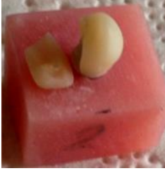
Şekil 3.11. Ti-Base zirkonya destek üzerindeki Lava Ultimate kronun tek parçalı kırığı
