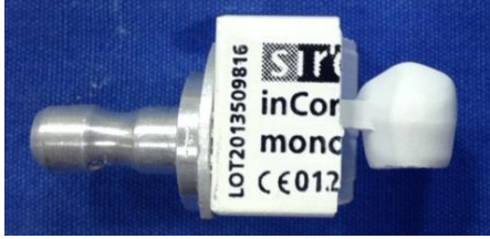
Şekil 2.15. Sirona Dental Sistem presinterize inCoris TZI Mono S meso bloktan üretilmiş monolitik zirkonya kron
