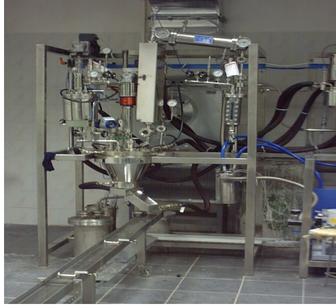
Şekil 3.3. Polikondensasyon reaksiyonlarının yapıldığı pilot tesis
