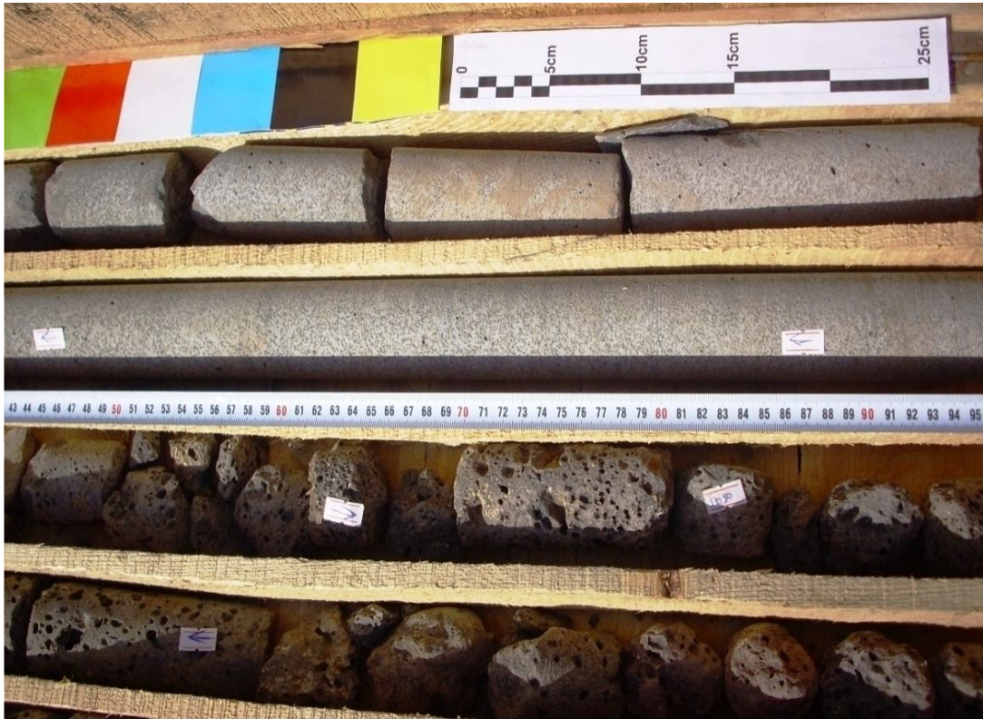
Şekil 4.47. Boşluklu ve masif bazaltlardan elde edilen numunelerin arasındaki fark durumu
