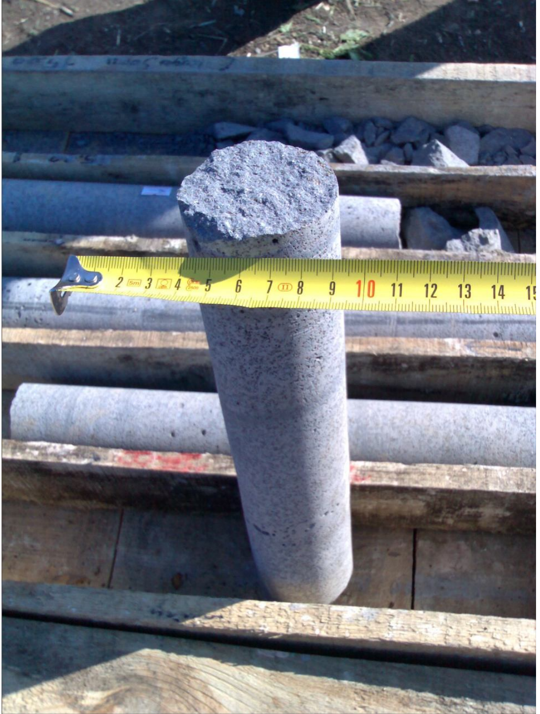
řekil 4.28. Karotlu sondajdan elde edilen masif bazalt örneęi
