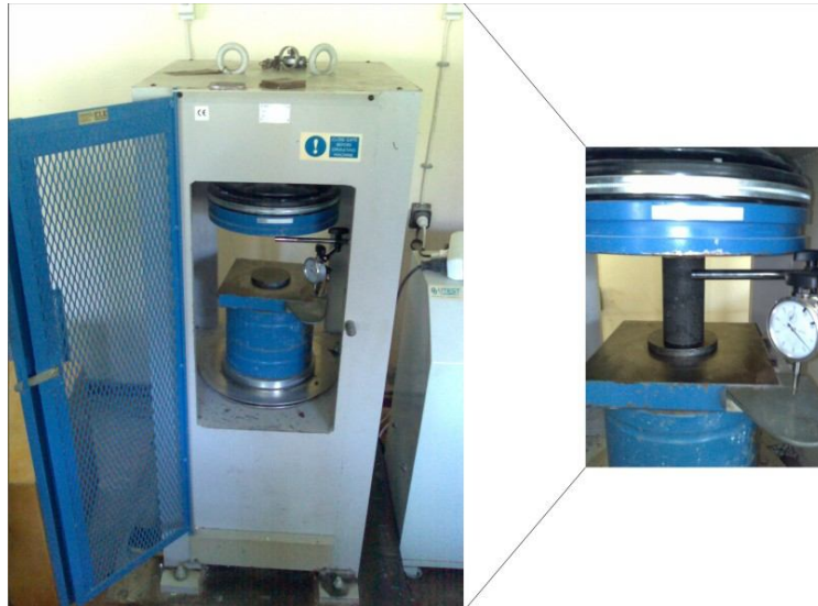
Şekil 3.4. Tek eksenli sıkışma dayanımında kullanılan ekipman ve deneye ait görüntüler
