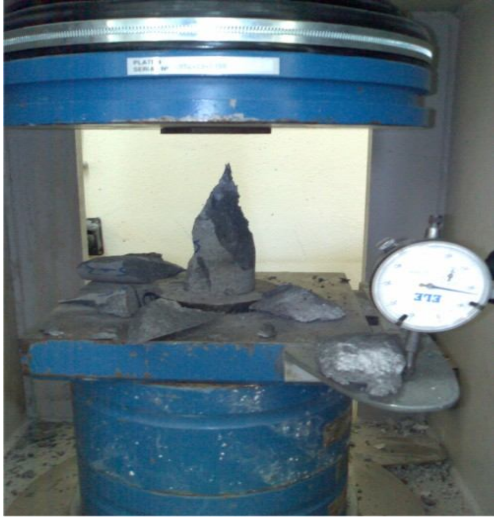
Şekil 4.39. Kuru haldeki bazalt numunesinin kırılma biçimi
