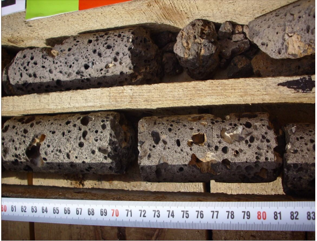
Şekil 4.29. Karotlu sondajdan elde edilen gaz boşluklu bazalt örneği
