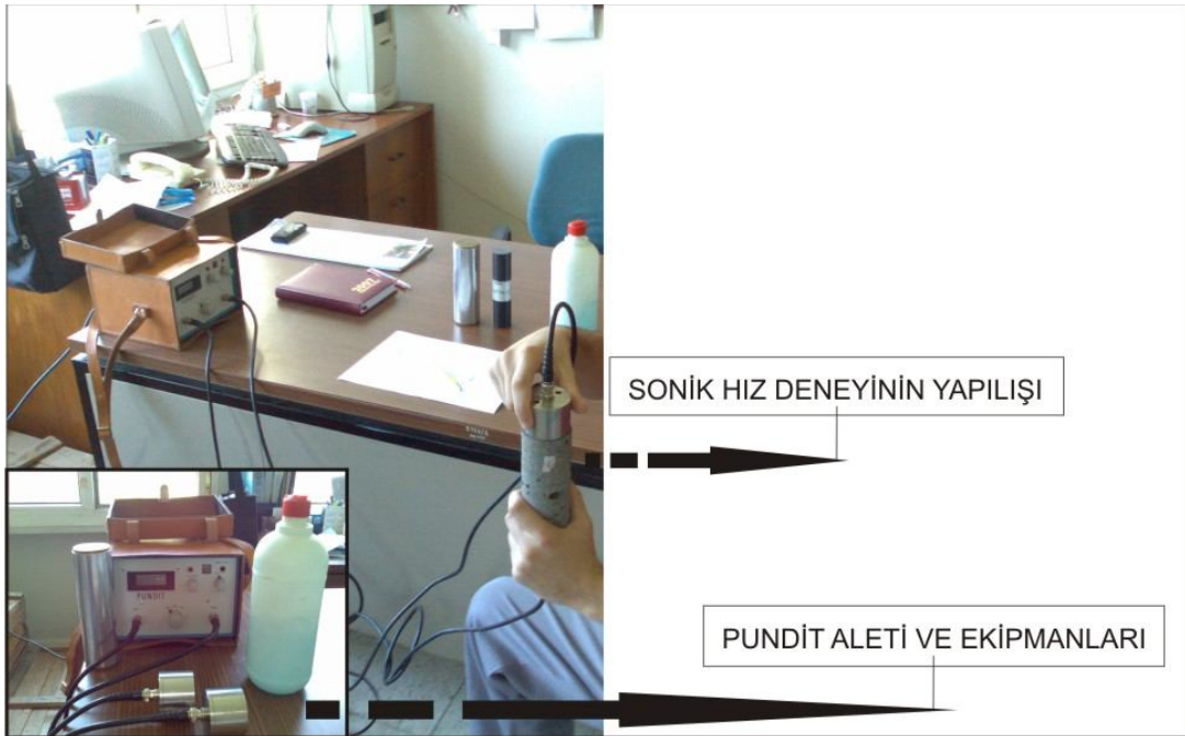
Şekil 3.5. Sonik hız deneyinin yapılışı, kullanılan pundit aleti ve ekipmanları
