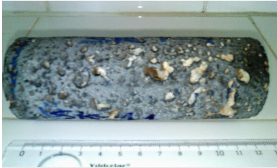
Şekil 4.22. Gaz boşlukları içerisinde meydana gelen kalsitleşmeler
