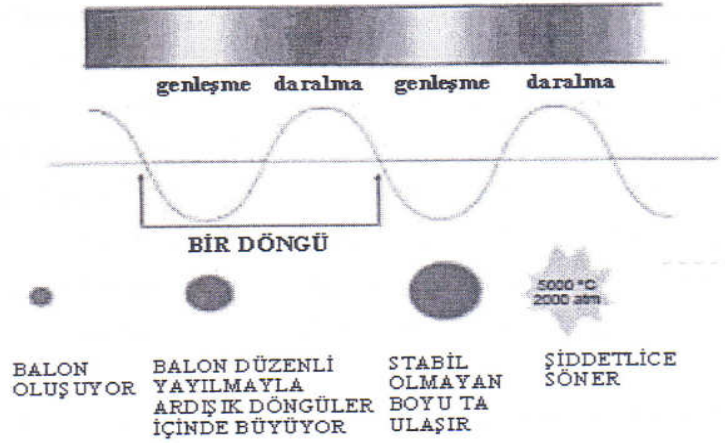
Şekil 3.2 Sıvı içinde sesin yayılmasıyla kaviteasyon balonunun oluşumu ve sönməsi
