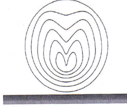
Şekil 3.9 Katı yüzey yakınında balonun çökmesi sırasında oluşan mikro jet
