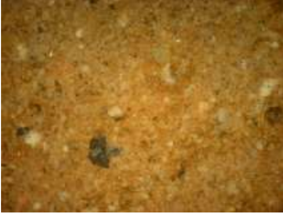
Şekil 9.22 900 °C’de pişirilmiş %30 atık il. numune, büyütme 50x DIC
