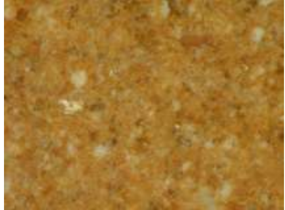
Şekil 9.9 900 °C’de pişirilmiş katkısız numune, büyütme 100xDIC
