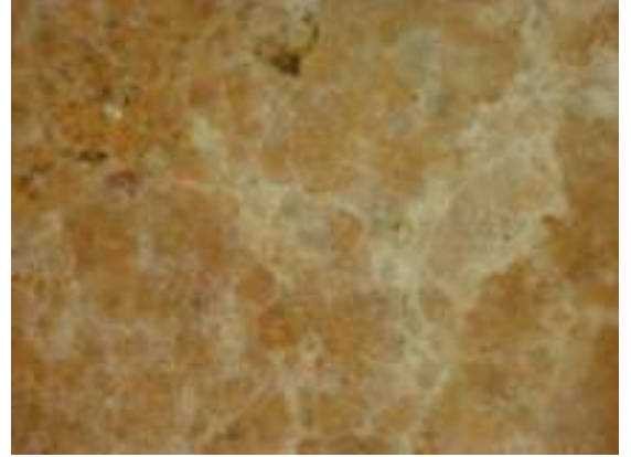
Şekil 9.13 900 °C’de pişirilmiş %5 il. numune, büyütme 100xDIC
