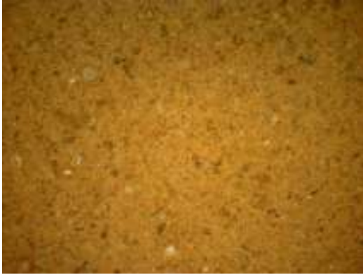
Şekil 9.6 800 °C’de pişirilmiş katkısız numune, büyütme 50x
