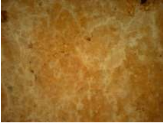
Şekil 9.12 900 °C’de pişirilmiş %5 atık il. numune, büyütme 50x DIC
