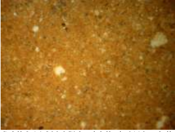
Şekil 9.14 800 °C’de pişirilmiş %10 atık il. numune, büyütme 50x DIC
