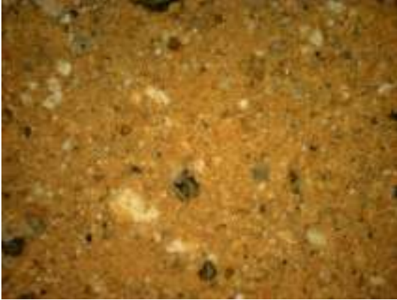
Şekil 9.20 900 °C’de pişirilmiş %20 atık il. numune, büyütme 50x DIC
