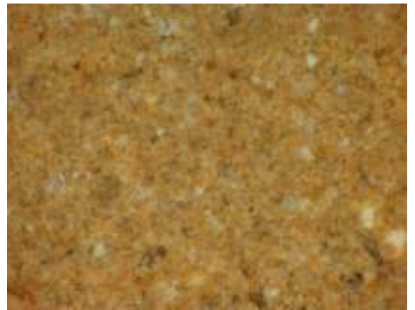
Şekil 9.17 900 °C’de pişirilmiş %10 il. numune, büyütme 100xDIC
