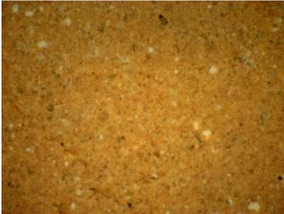
Şekil 9.16 900 °C’de pişirilmiş %10 atık il. numune, büyütme 50x DIC
