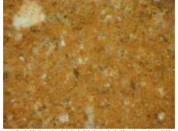
Şekil 9.15 800 °C’de pişirilmiş %10il. numune, büyütme 100xDIC
