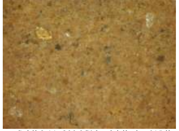
Şekil 9.11 800 °C’de pişirilmiş %5 il. numune, büyütme 100xDIC
