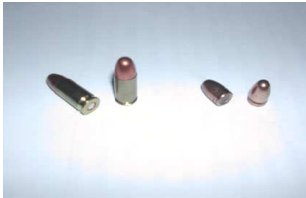
Şekil 3.7 Mermi testlerinde kullanılan 9 mm FMJ makineli tabanca mermisi
