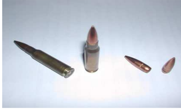
Şekil 3.8 Mermi testlerinde kullanılan 7.62 mm NATO normal mermi ve çekirdeği
