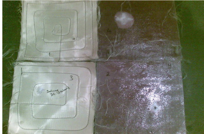
Şekil 6.4 Polyester reçine kaplı E cam elyaf/Cam keçe /Kevlar 49 hibrit kompozit numunesi.
