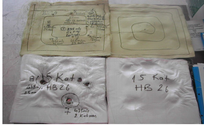
Şekil 6.33 Atış sonrası Kevlar 49 /Polietilen HB26 UHMW-PE hibrit kompozit numune katmanlarının görünümü.
