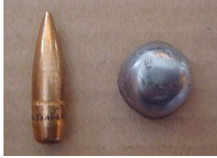
Şekil 3.11 7,62x51 mm normal merminin deformasyon öncesi ve sonrası görünümü
