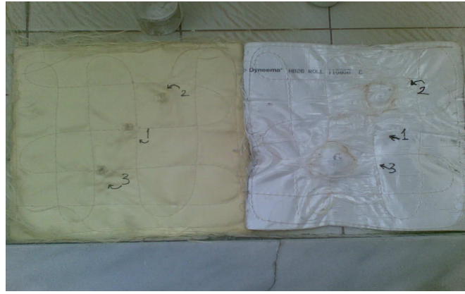
Şekil 6.45 Yapılan atışlar sonrası; (a) (Kevlar 49 ) 10 , (b) (Polietilen HB26 ) 10 ] numune katmanlarının arka yüz çöküntü durumu görüntüleri.
