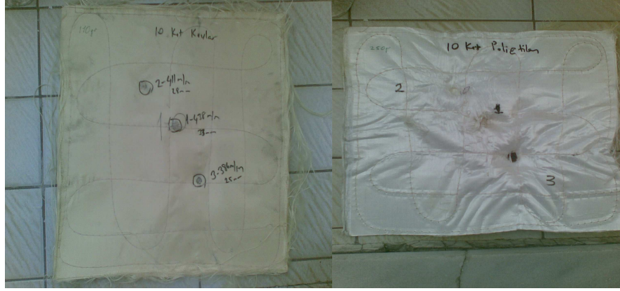
Şekil 6.44 Yapılan atışlar sonrası; (a) (Kevlar 49 ) 10 , (b) (Polietilen HB26 ) 10 ] numune katman görüntüleri.
