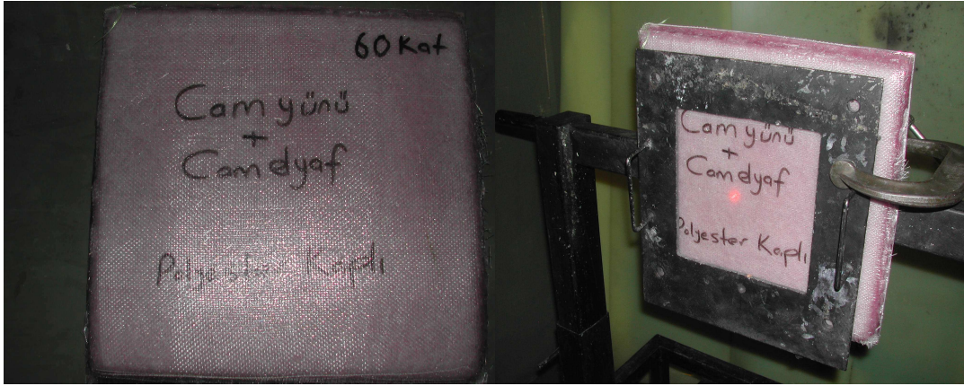
Şekil 6.2 Polyester reçine kaplı E cam elyaf/cam keçe/polyester reçine kompozit plaka numunesi.
