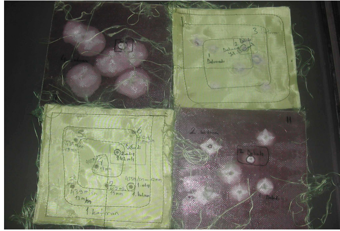
Şekil 6.28 Atış sonrası numune katmanlarının görünümü.
