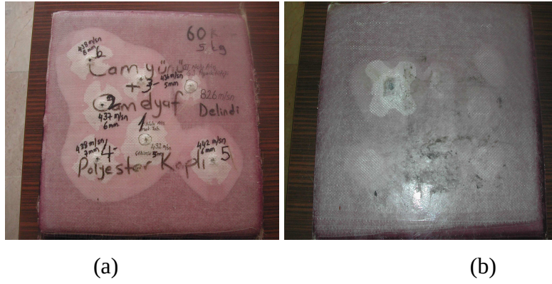
Şekil 7.3 Atış sonrası; (a) [E cam elyaf/cam /polyester reçine] 60 plakası ön yüz, (b) [E cam elyaf/cam keçe/polyester reçine] 60 plakası arka yüz görüntüleri.
