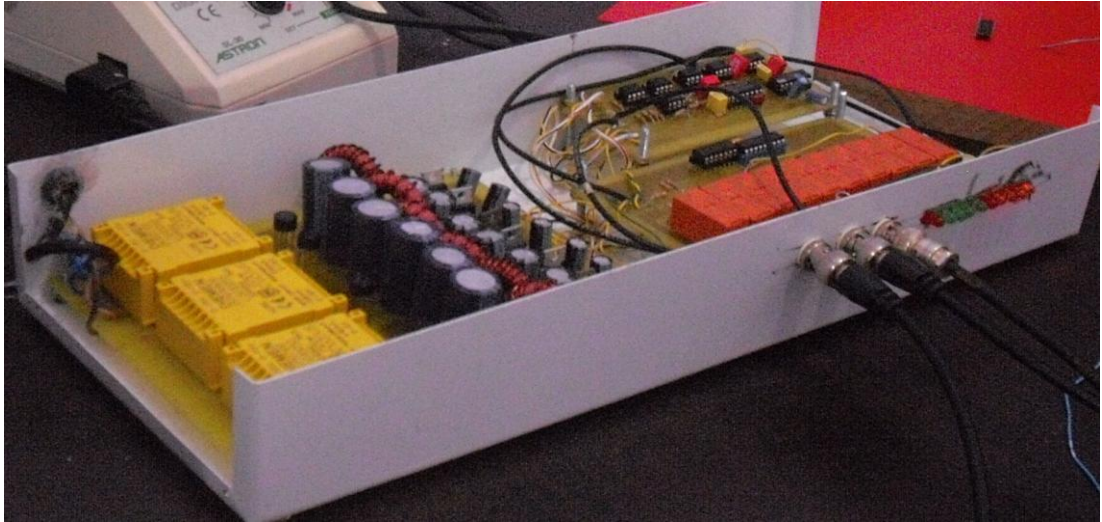
Şekil 4. 10 Tasarlanan lock-in amplifikatörün görünümü
