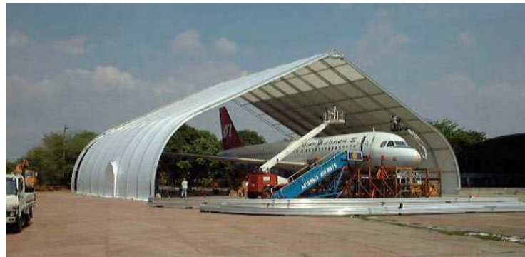
Şekil 2.2. Portatif sığınakta uçağın bakımı.
