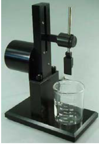
Şekil 3. 3 Daldırarak kaplama düzeneği
