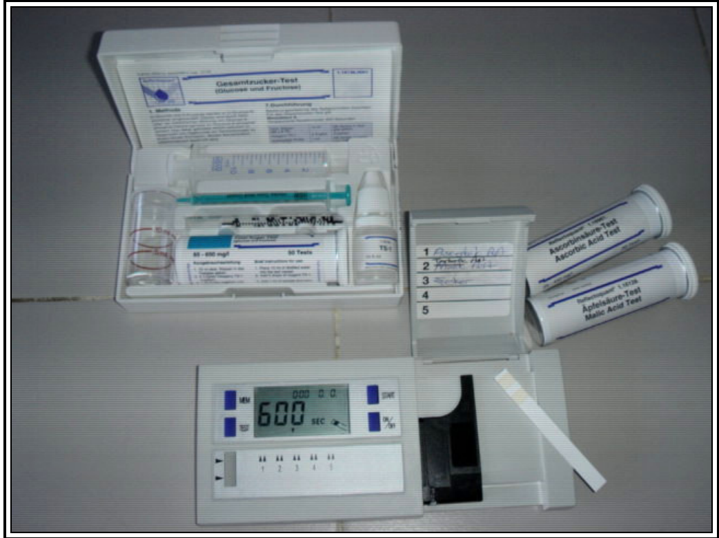
Şekil 3.8. Askorbik asit, malik asit ve indirgen şeker tayininin yapıldığı “RQflex plus 10” cihazı (orijinal)
