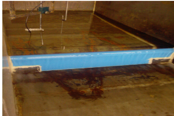
Şekil 4.8 Savaşın sete yerleştirilmesi
