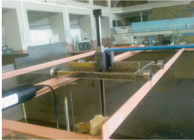
Şekil 4.14 Ray sistemi ve ölçüm arabası
