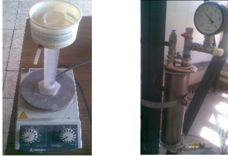
Şekil 6.1 CHF sistemine ait hücre ve basınç kabı.
