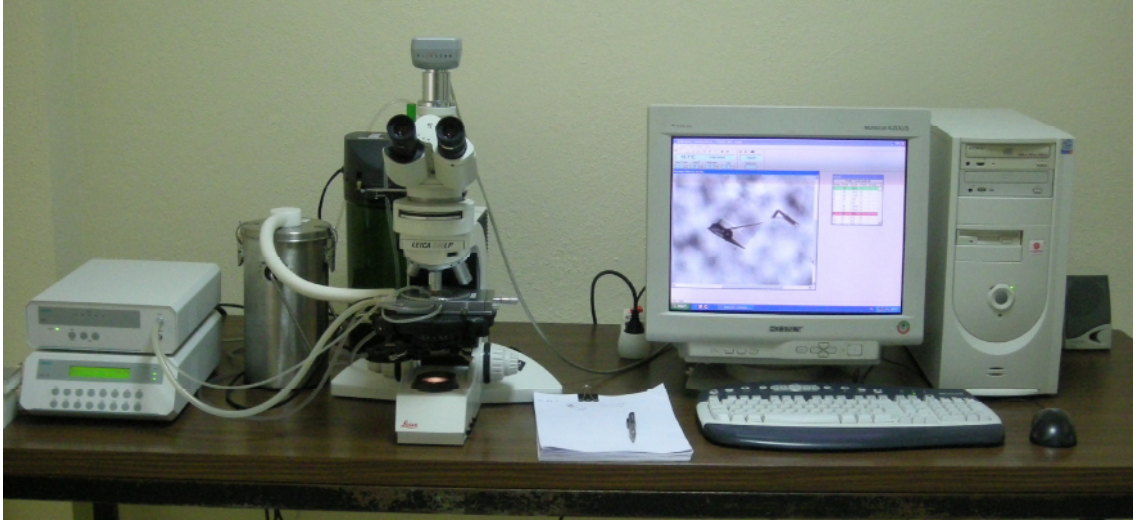
Şekil 4.2 600 °C ısıtma ve -196 °C soğutma yapabilen LINKAM THMG-600 ısıtma – soğutma sistemi.
