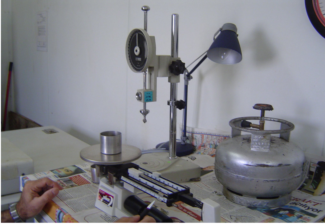
Fotoğraf 2.7 Penetrasyon deneyinin yapılışından görünüm
