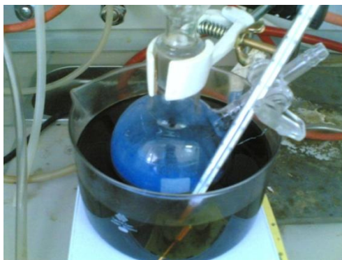
Şekil 3.23. 9 –Metoksifenantren (3)'in eldesinde reaksiyon düzeneği
