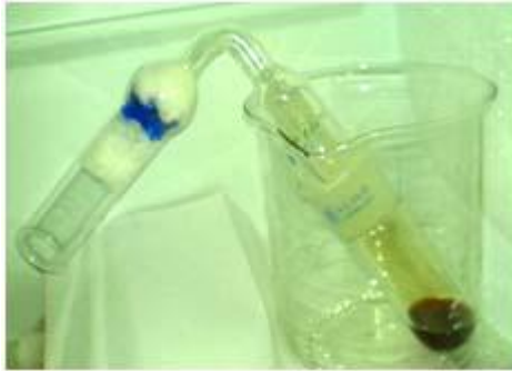
Şekil 3.1. Bromlama reaksiyon düzeneği
