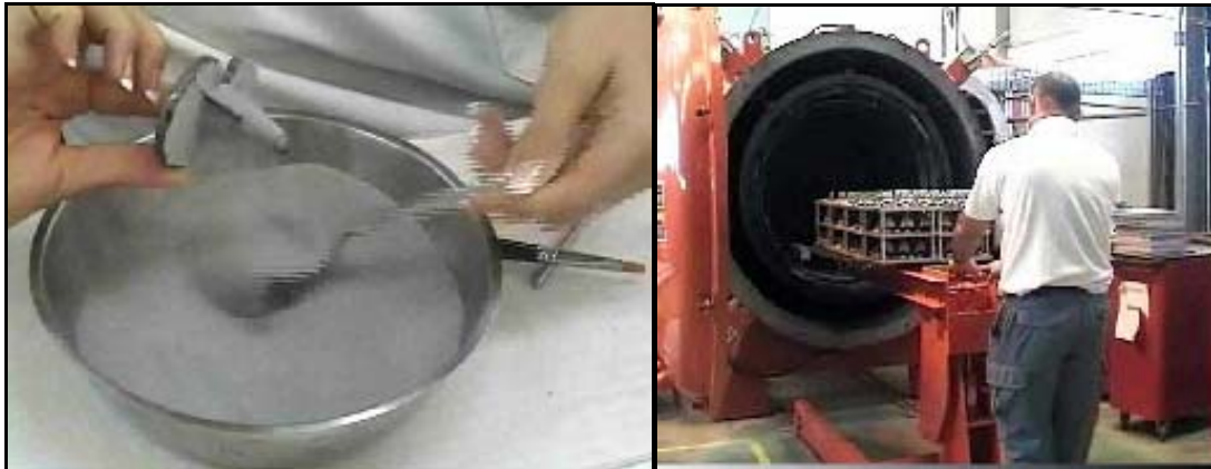
Şekil 3: Bir tibial komponentin kumlanması (solda) ve sinterleme fırını (sağda) (Resimler Bio-vac Espana S.A şirketinin web sitesinden alınmıştır).
