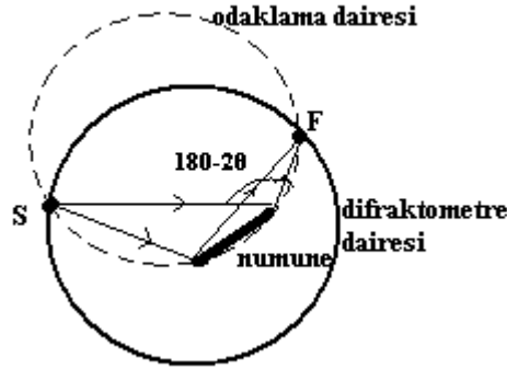
Şekil 5.8. Difraktometrenin odaklama geometrisi.
