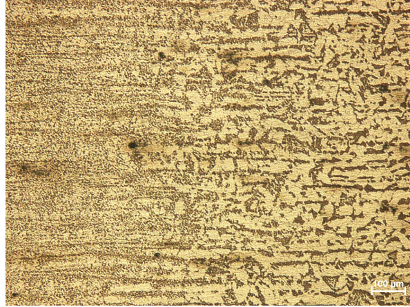
Şekil 5.13 A kompozisyonundaki çeliklerin ITAB ve ana malzeme bölgelerini içeren optik mikroskop görüntüsü (200X)
