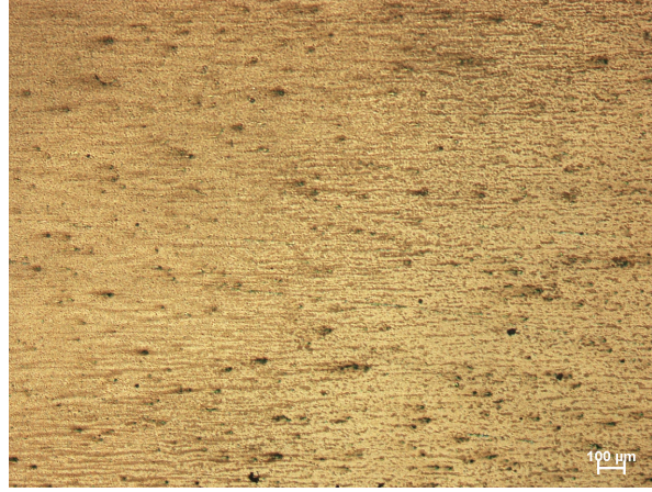
Şekil 5.18 B kompozisyonundaki çeliklerin ITAB ve ana malzeme bölgelerini içeren optik mikroskop görüntüsü (50X)
