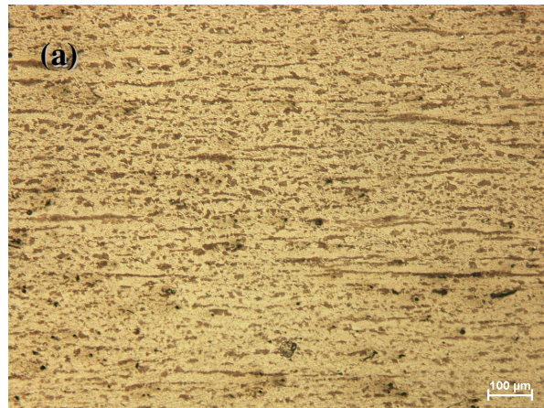
Şekil 5.21 B kompozisyonundaki çeliklerin ITAB bölgesini gösteren (a)200X, (b)500X optik mikroskop görüntüleri
