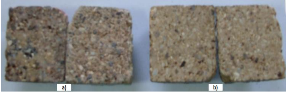
Şekil 7.4 a) Ca-825 numunesinin test sonrası kesit görünümü
