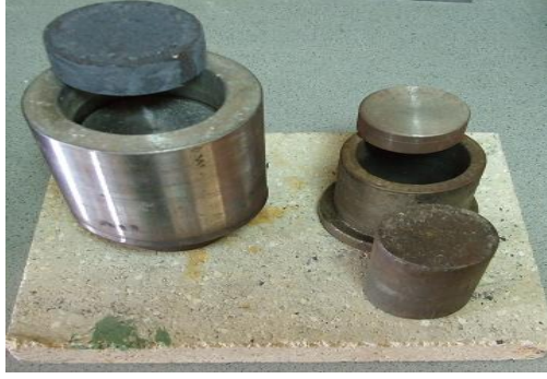
Şekil 6.2 Numune presleme için yapılan kalıplar (solda 50 mm. ve sağda 40 mm. çaplı)
