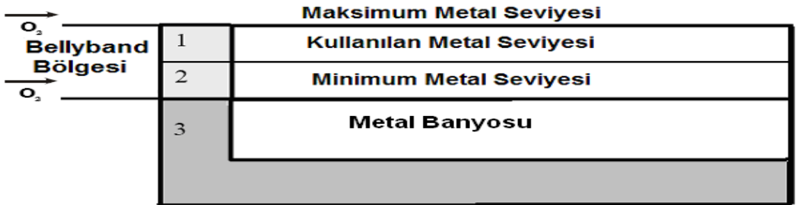
Şekil 4.1 Alüminyum ergitme fırınındaki bölgeler (James vd., 2008)
