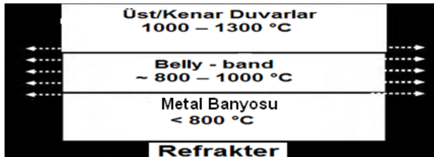
Şekil 3.1 Alüminyum ergitme ve bekletme fırınının tipik görünümü (Allaire ve Guermazi, 2000a)
