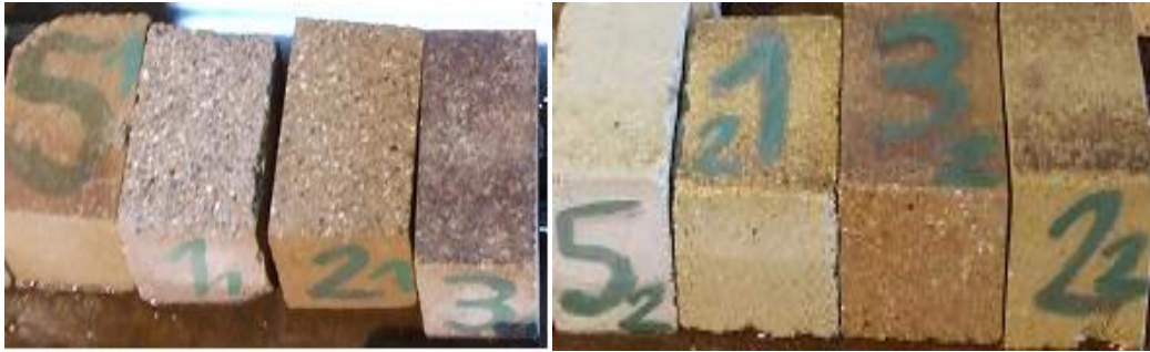
Şekil 6.9 Endüstriyel çalışmalarda temperlenmiş (solda) ve pişirilmiş (sağda) tuğla görünümleri( 1-D-B80, 2-D-P, 3-D-P-Ba, 5-D-Ca)
