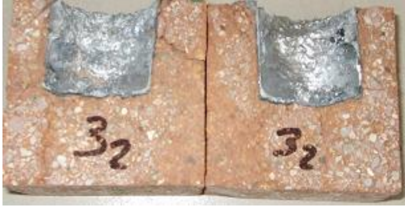
Şekil 7.14 D-P-Ba-1350 numunesinin test sonrası kesit görünümü
