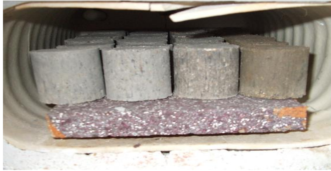
Şekil 6.6 Basılan numuneler ve numunelerin temperlenmesinde kullanılan laboratuvar tipi fırın
