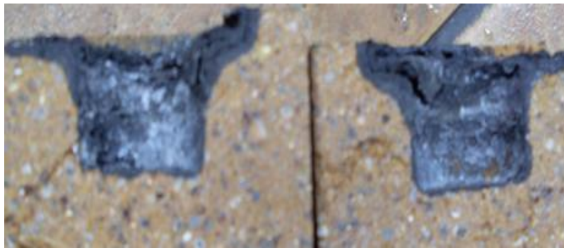
Şekil 7.8 Fosfat bağlı %60 alüminalı tuğlanın test sonrası kesit görünümü
