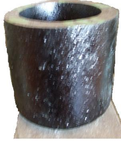
Şekil 6.5 Korozyon deneylerinde kullanılan potanın pişmemiş ve kullanılmamış görünümü
