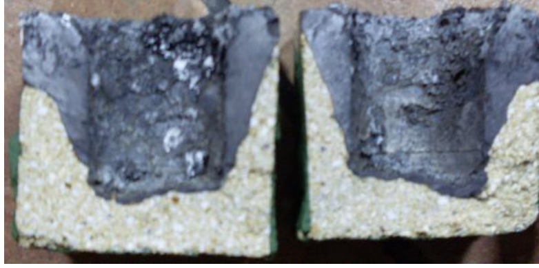
Şekil 7.6 %50 Alüminalı tuğlanın test sonrası kesit görünümü
