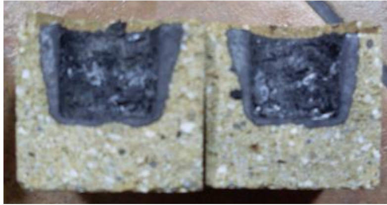
Şekil 7.7 %60 Alüminalı tuğlanın test sonrası kesit görünümü
