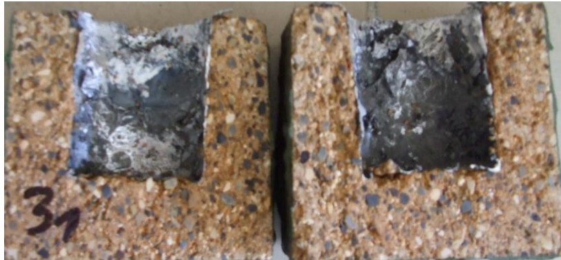
Şekil 7.11 D-P-Ba-825 numunesinin test sonrası kesit görünümü
