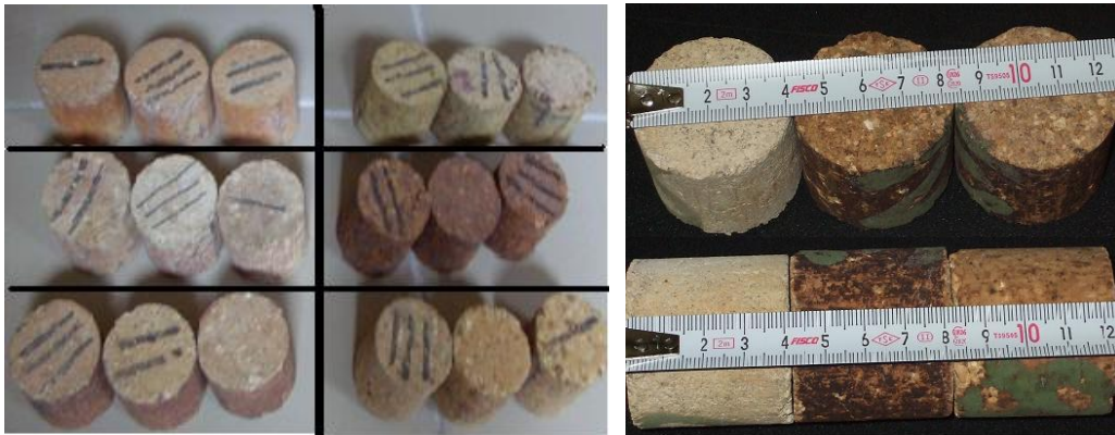
Şekil 6.7 Numunelerin temper (solda) ve pişirme sonrası görüntüleri (alt P, orta P-Ba, üst Ca) ve pişmiş numunelerin boyut ölçümleri
