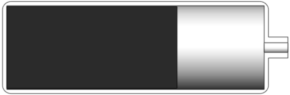
Şekil 3.1 Doğal ısı taşınımı tüp şeklinde Metal-hidrür hidrojen depolama reaktörü. (Reaktör-1)
