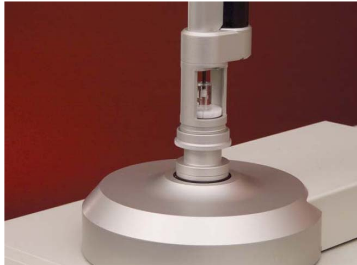
Şekil 3.3. ITC cihazının şırınga sistemi. Şırınga ITC deneyi boyunca yerinde döner. Şırınganın ucu ITC hücresi içinde sürekli karıştırmayı sağlamak için adapte edilmiştir. Pompa bilgisayar kontrollüdür ve ligand hacimlerini doğru şekilde enjekte eder.
