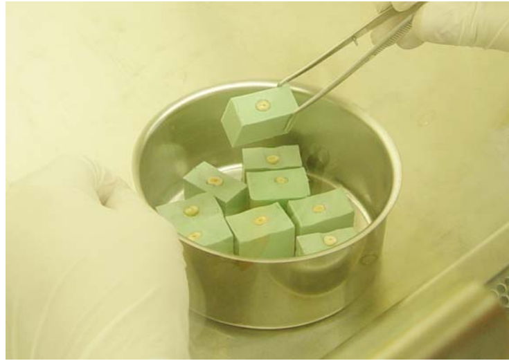
Resim 2.1: Steril edilmiş ve silikon bloklara gömülmüş köklerin içinde bulunduğu metal kap
