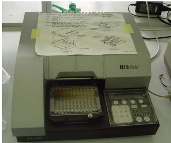
Resim 2.6: Deneyde optik yoğunluk ölçümleri (OD) için kullanılan ELISA okuyucusu
