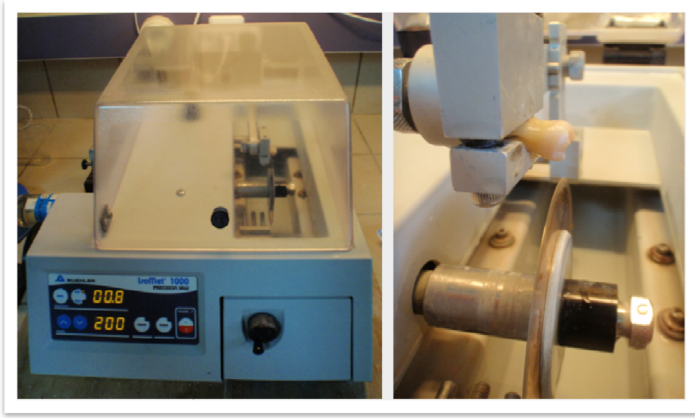
Resim 2.1 Dentin disklerinin elde edilmesinde kullanılan cihaz ve kesme işlemi.
