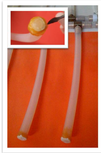
Resim 2.4 Dentin disklerinin silikon hortumların uçlarına mum ile sabitlenmesi.
