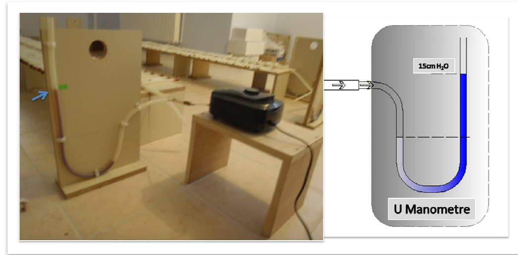
Resim 2.9 Düzeneğin başında ve sonunda kullanılan kontrol “U” manometreleri ve “U” manometresinin şematik çizimi.
