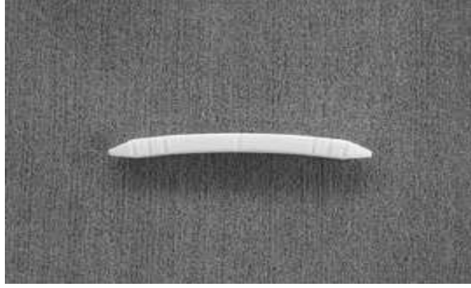
Şekil 12. Kawachi ve arkadaşlarının (30) kullandığı Hydroxyapatite ve poly - L- lactide içeren emilebilir kosta yaklaşırma çivisi. Çivin boyutları ince tip 2 mm x 2 mm x 27 mm, kalın tip ise 3 mm x 3 mm x 34 mm dir.
