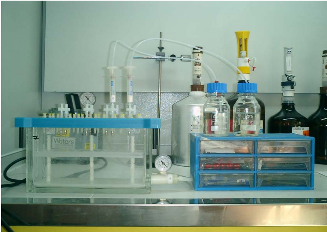
Resim 4.2. Analizlerde kullanılan vakum manifoldu ve C 18 kartuşlar
