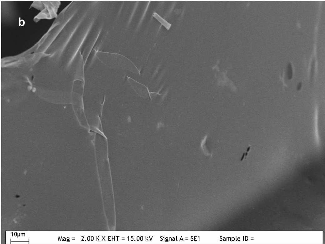
Şekil 3.15.b) Hücre içermeyen poliüretan sünger (2000x büyütme)
