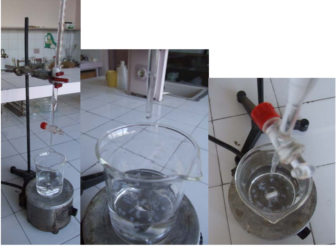
Şekil 3.5. Ca-alginat boncuklarının oluşturulduğu düzenekler.
