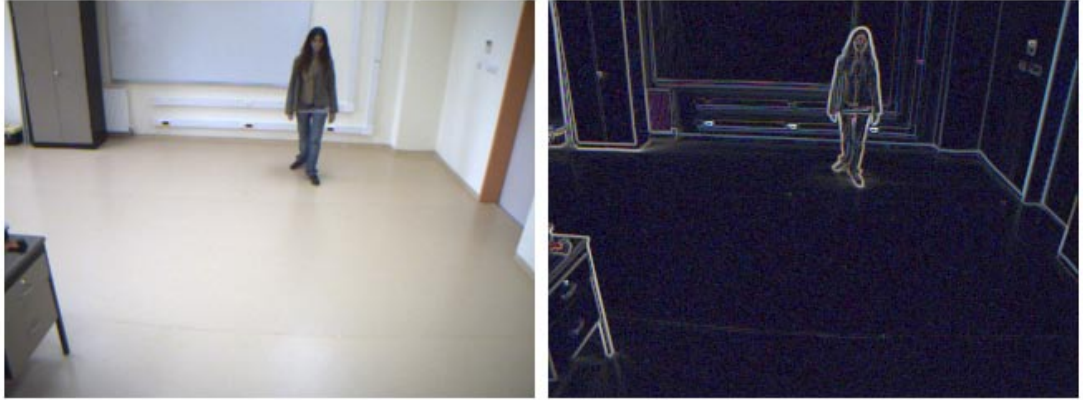
Şekil 9: Örnek bir resim ve hesaplanmış resim gradyanı. Resim gradyanı nesne sınırlarında yüksek değerlere sahiptir.
