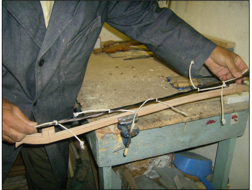
Resim-45 (Yay kısmına at kılının takılma işlemi)
