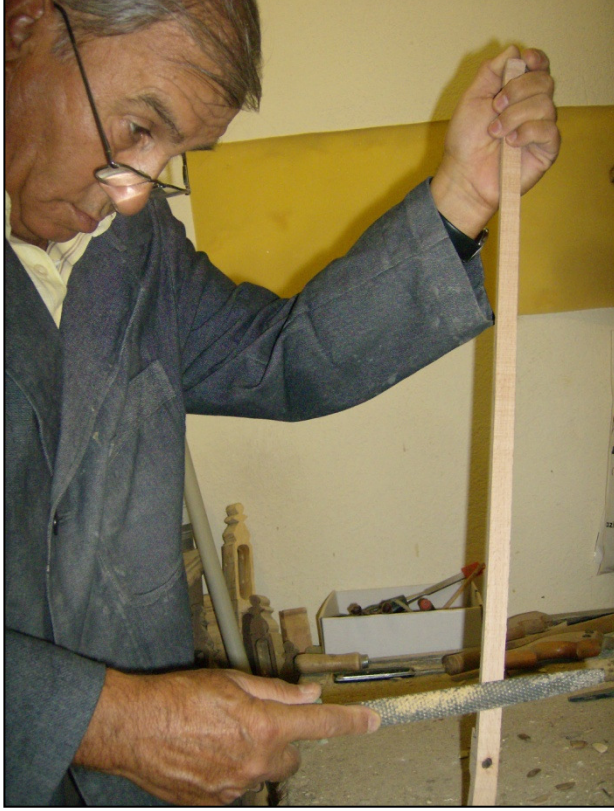
Resim-44 (Yay kısmının hazırlanması)
