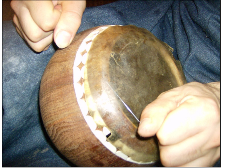
Resim-26 (Gövde kısmının üzerine misina yardımıyla derinin gerilmesi)
