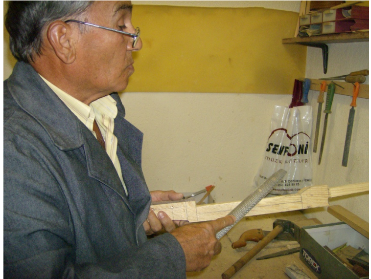
Resim-35 (Kabak kemanenin sap kısmının törpü ile yuvarlaklaştırılması)
