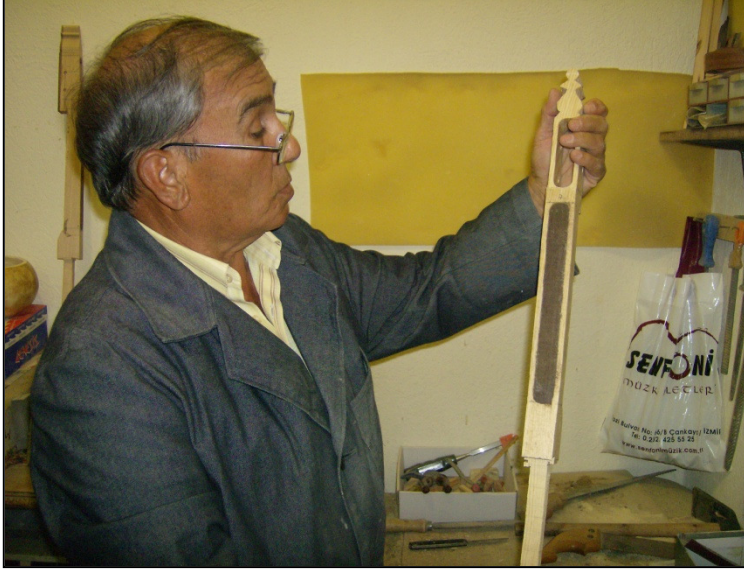
Resim-34 (Kabak kemanenin sap kısmının hazırlanması)
