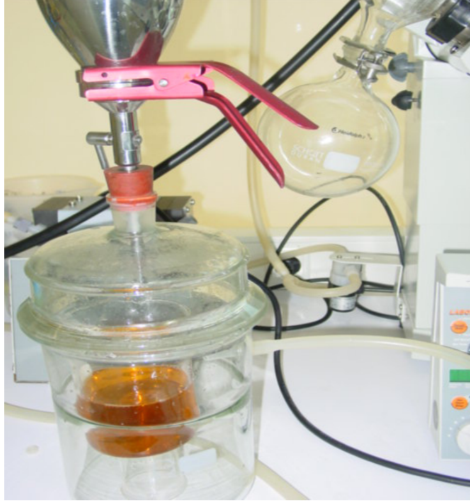
Şekil 4.6 2 gr/L aktif karbon uygulamasından sonra keçiboynuzu ekstraktının filtrasyonu
