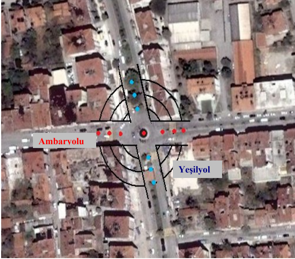
Şekil 3.6 Eş zamanlı dairesel ölçüm metodunun şematik görüntüsü.
