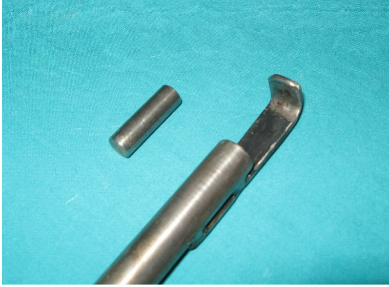
Şekil 6. Çalışmada kullanılan borunun alt ucundaki kaşık mekanizması ve travma oluşturmak için kullanılan 20 gr ağırlığındaki silindir.
