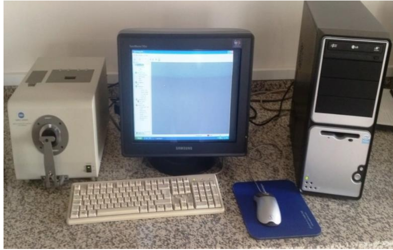
Şekil 3. 10. Konica Minolta CM-3600d cihazı ile renk ölçümü
