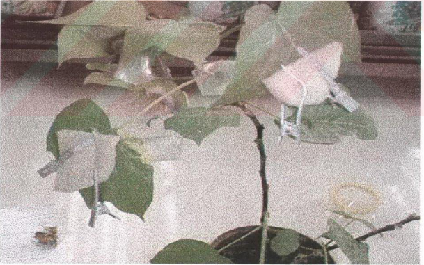
Şekil 3.5. Bemisia tabaci 'nin üreme ve ergin ömür uzunluklarını gözleyebilmek için kullanılan kafesler.
