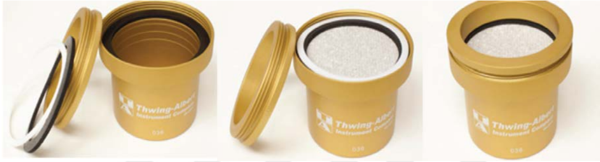
Şekil 2.7. Thwing-Albert, 68-3000 Vapometer EZ-Cups
