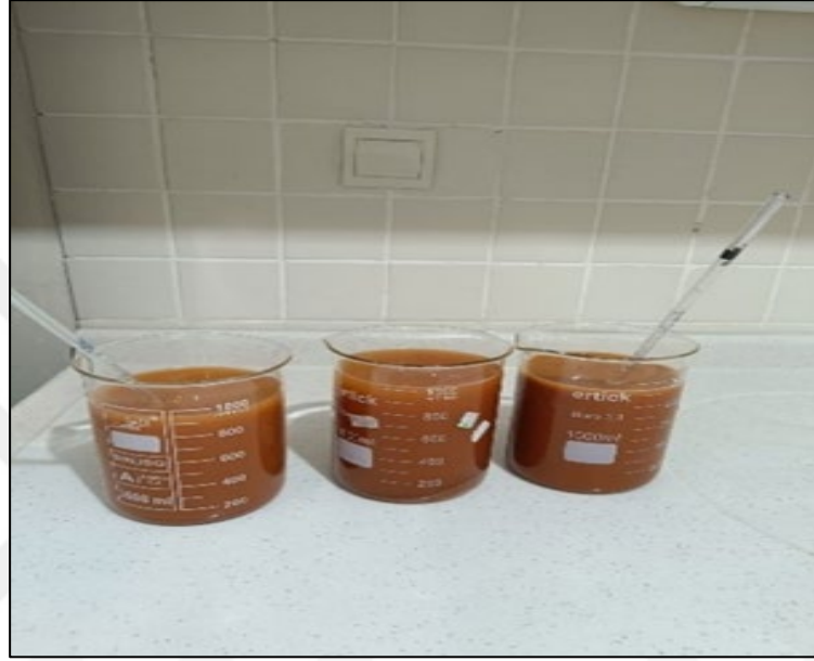
Şekil 3.2 Bitlis/Mutki kilinin saf su ile yıkanması işlemi
