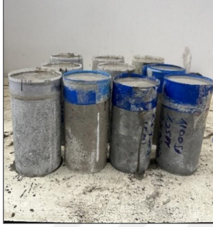
a) Numunelere çimento şerbetiyle başlık yapılması
