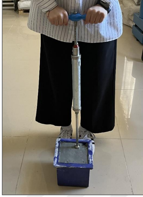
Şekil 3.20: Beton penetrasyon direncinin ölçülmesi
