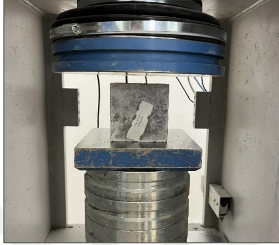
řekil 3.22: Basın dayanımı test dzeneęi
