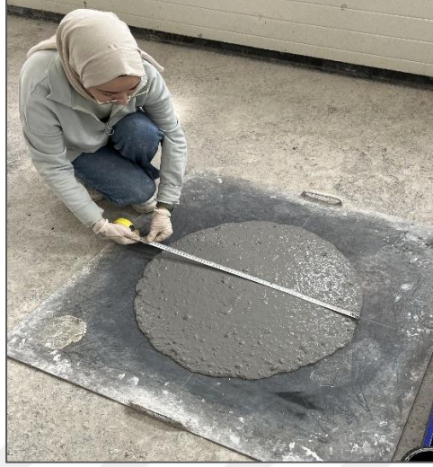
řekil 3.16: kme-yayılma deneyi
