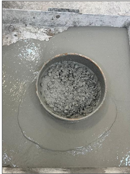
řekil 3.19: Taze betonun 4.75 mm elekten elenmesi
