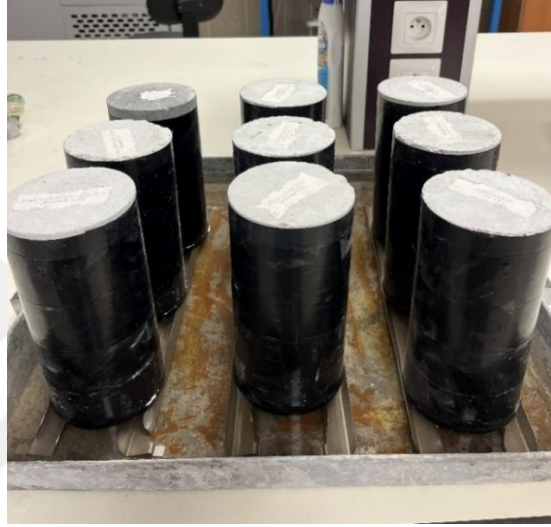
Şekil 3.25: Kılcal su emme deney düzeneği
