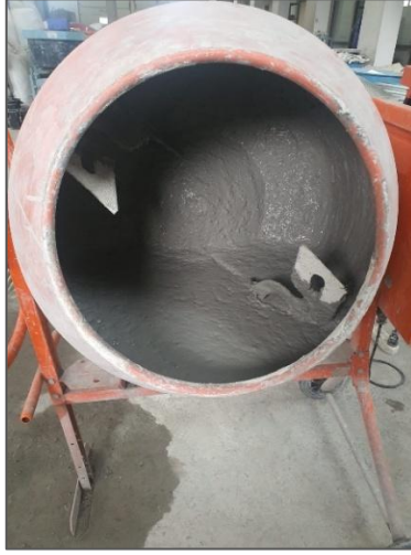
Şekil 3.11: Hazırlanan çimentosuz KYB karışımı
