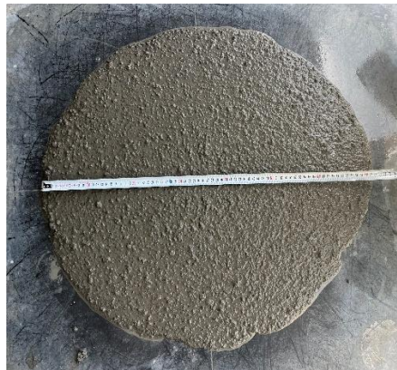
Şekil 4.2: Kontor KYB karışımına ait çökme-yayılma görseli
