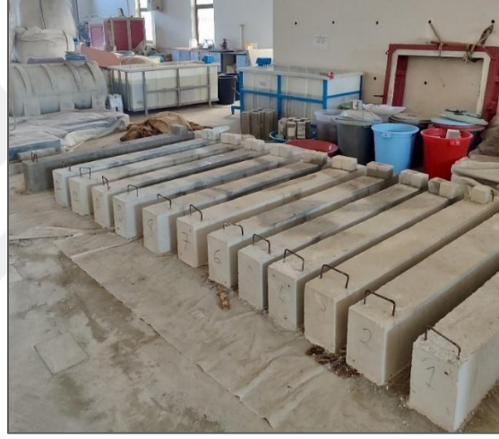
b) Dökümü tamamlanıp kalıptan çıkarılan betonarme kirişler
