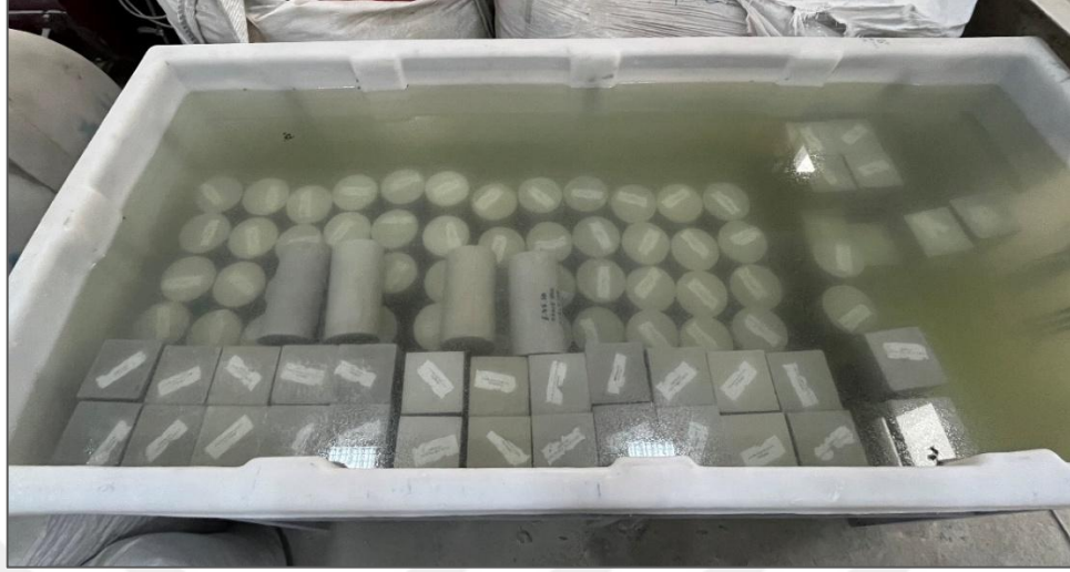
Şekil 3.13: Numunelerin kür edilmesi
