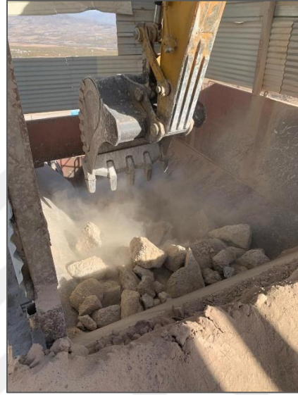
a) Yıkıntı atığı beton blokların konkasöre boşaltılması
