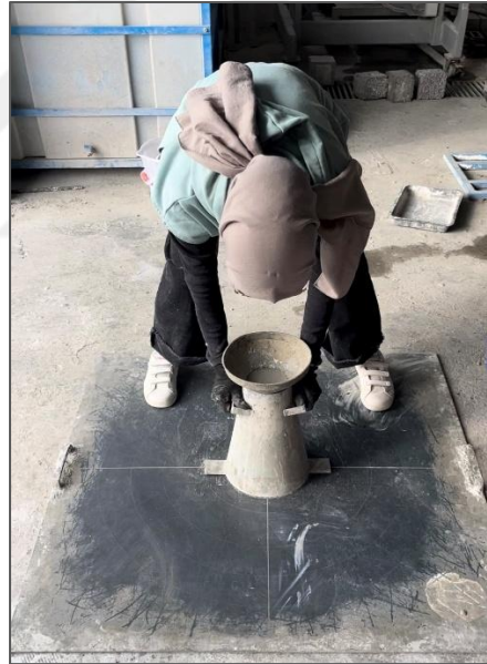
Şekil 3.15: Çökme-yayılma ve T_{500} deney düzeneği
