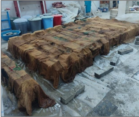
b) Dökümü tamamlanıp kalıptan çıkarılan betonarme kirişler
