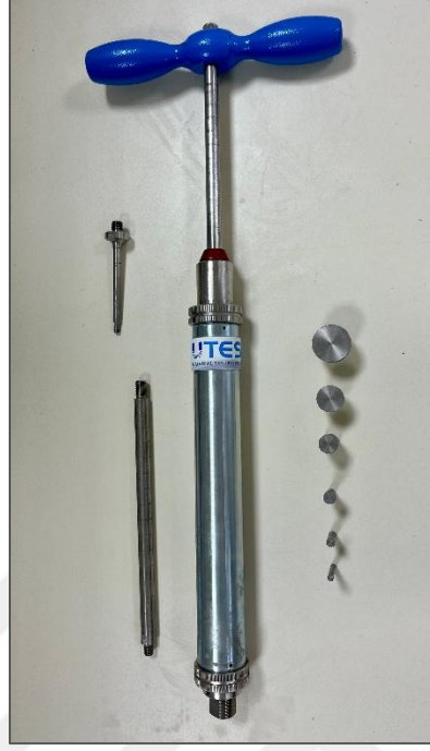
řekil 3.18: Beton harç penetrometresi
