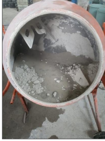
Şekil 3.8: Su ve akışkanlaştırıcının ilave edilmesi
