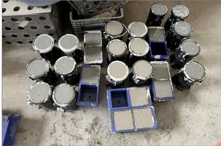
Şekil 3.12: Sertleşmiş beton özelliklerinin belirlenmesi için numunelerin üretilmesi
