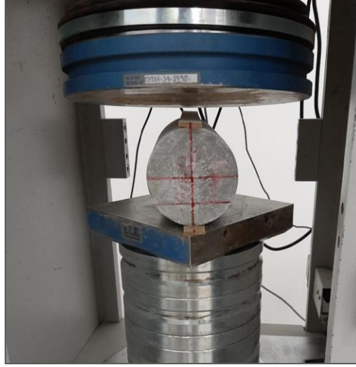
Şekil 3.24: Yarmada çekme dayanımı test düzeneği
