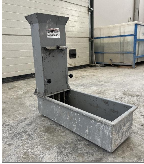
Şekil 3.17: L kutusu deney aparatı
