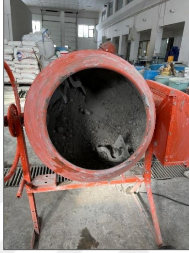
Şekil 3.5: Tez çalışması deneylerinde kullanılan drum tipi beton mikseri
