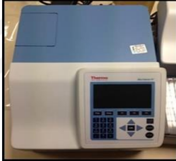
Şekil 3.7: Mikroplak optik okuyucu; Spektrofotometre (Thermo Scientific Multiskan FC, 2011-06, USA)
