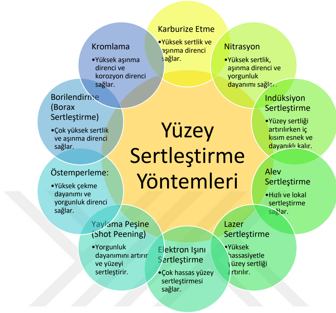
Şekil 4.1: Yüzey sertleştirme yöntemleri
