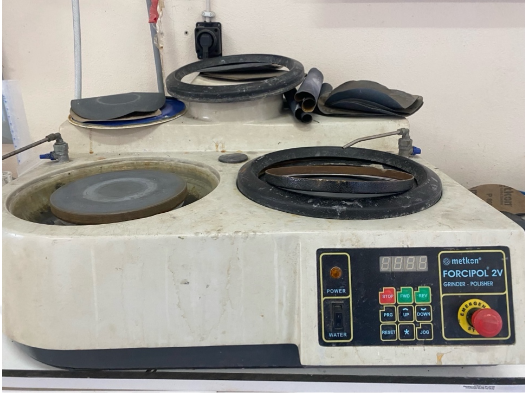
Şekil 5.7: Forcipol 2V model zımparalama ve parlatma cihazı
