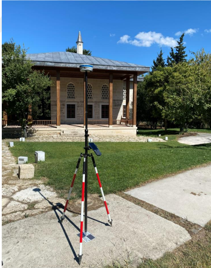
Şekil 3.10 Yapı çevresindeki yer kontrol noktalarının RTK GNSS ile ölçümü
