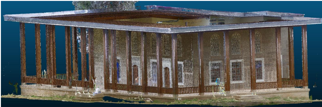
Şekil 4.1 Yersel lazer tarayıcı verisinden üretilen RGB nokta bulutu
