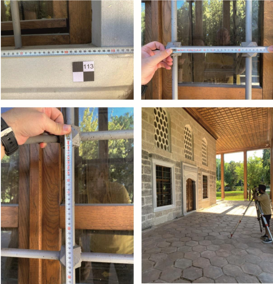
Şekil 3.11 Yapı cephesinde çelik şerit metre ve total station ile yapılan ölçümler
