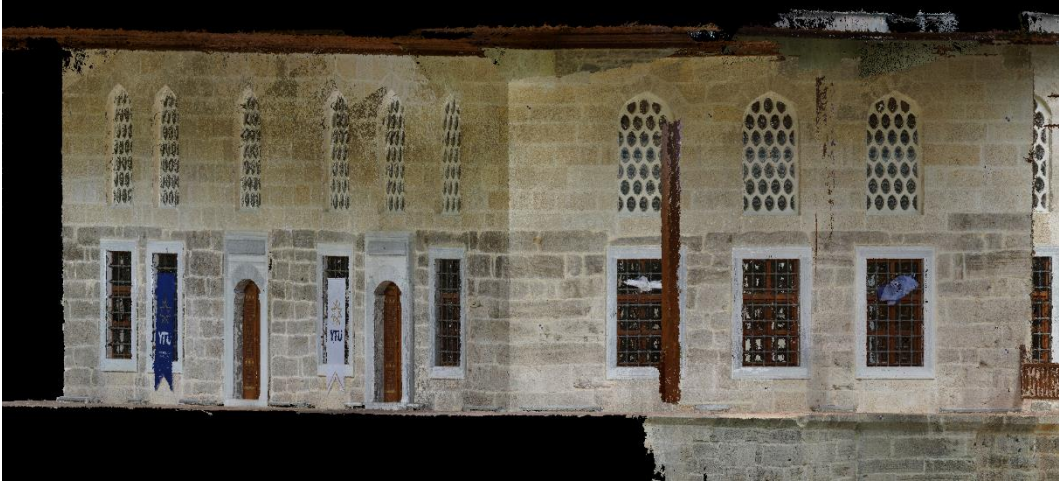
Şekil 4.3 Yersel fotogrametri verisinden üretilen RGB nokta bulutu
