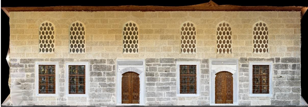
Şekil 4.5 Mobil LiDAR destekli fotogrametri verisinden üretilen Kuzey cephesi görünüşü
