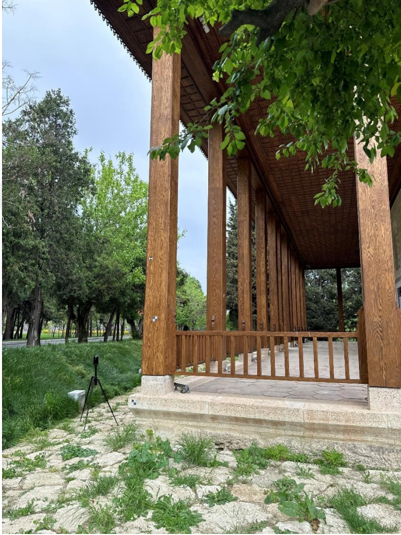
Şekil 3.12 Leica BLK 360 yersel lazer tarayıcı ile veri toplama
