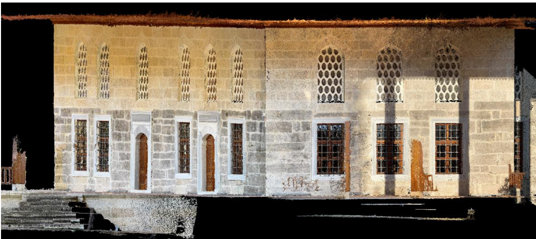
Şekil 4.4 Mobil LiDAR destekli fotogrametri verisinden üretilen RGB nokta bulutu
