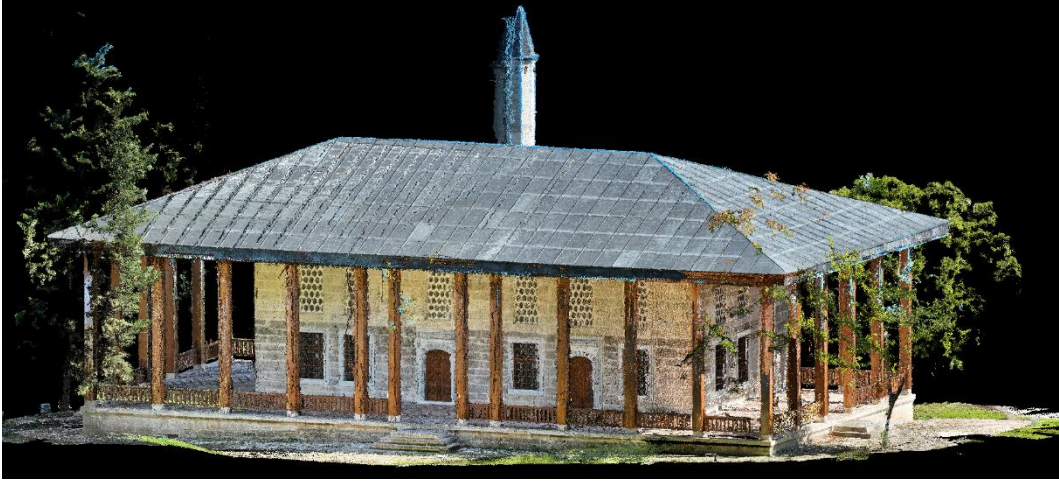
Şekil 4.2 İHA verisinden üretilen RGB nokta bulutu
