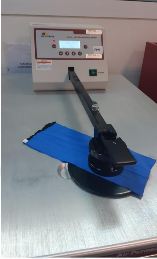
Şekil 3. 10. Hava geçirgenliği testi yapımı
