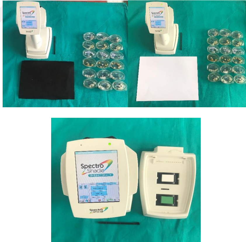
Şekil 3.8. Numunelerin renk ölçümü ve kullanılan spektrofotometre cihazı
