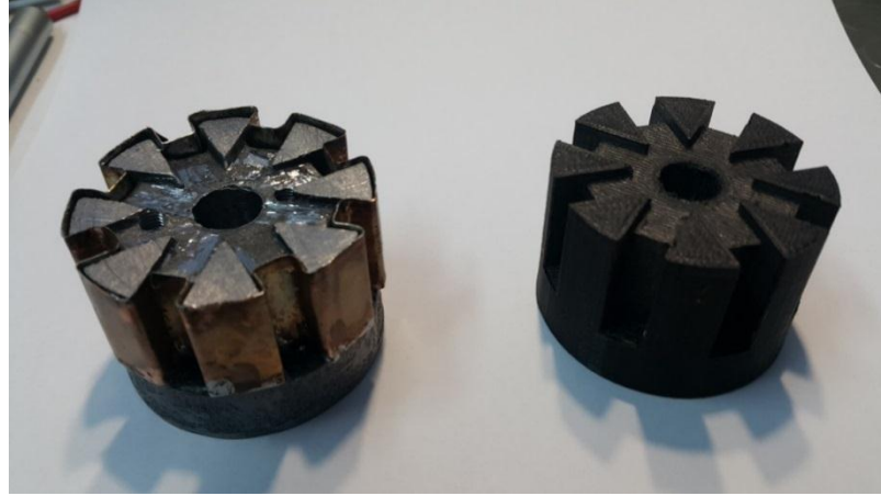
Şekil 3.12 Donma işleminden sonra fazlalıkları da alınmış olan montaja hazır dedektör gövdesi
