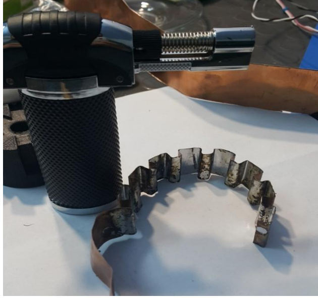
Şekil 3.10 Kurşun dedektör gövdesi içine yerleştirmek için şekillendirilmiş kalay ve bakır levha
