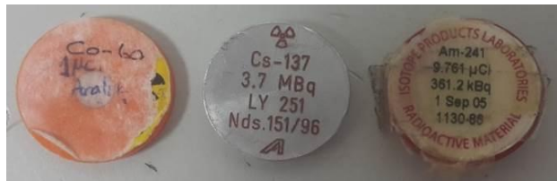
Şekil 4.2 Radyoaktif kaynaklar ( ^{241}\text{Am} , ^{137}\text{Cs} , ^{60}\text{Co} )
