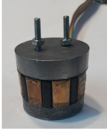
Şekil 3.15 Üst kapak dedektör gövdesine kılavuzla açılan vidalar
