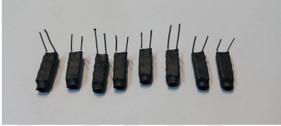
Şekil 3.4 Makaron boruların içine yerleştirilmiş olan BPW34 diyot dizileri
