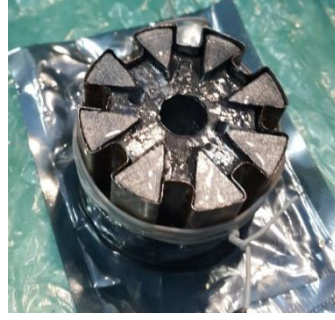
Şekil 3.11 Sıvı epoksi malzeme ile kaplanan dedektör bloğu
