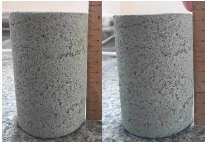
Şekil 5.26. Konsolidasyon deneyi sonunda 905 katkıli kek ve 923 katkıli kek.
