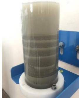
Şekil 4.9. Polimersiz bulamaç için tabakalı filtrasyon deneyi düzeneği fotoğrafı.
