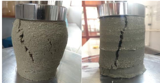
Şekil 5.28. Serbest basınç altında polimerli ve polimersiz kırılmış numuneler.
