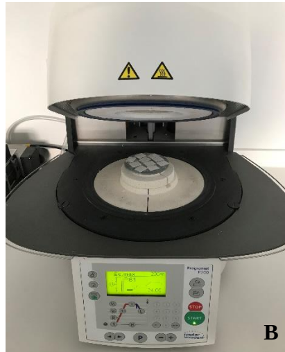
Resim 3.7. Glaze uygulaması, a) Kullanılan glaze materyali, b) Örneklerin fırına yerleştirilmesi
