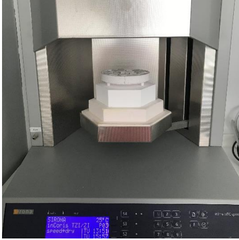
Resim 3.4. Sinterizasyon işlemi için örneklerin yerleştirilmesi
