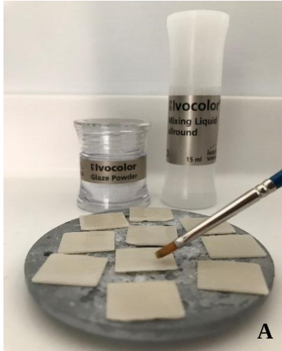
Resim 3.7. Glaze uygulaması, a) Kullanılan glaze materyali, b) Örneklerin fırına yerleştirilmesi
