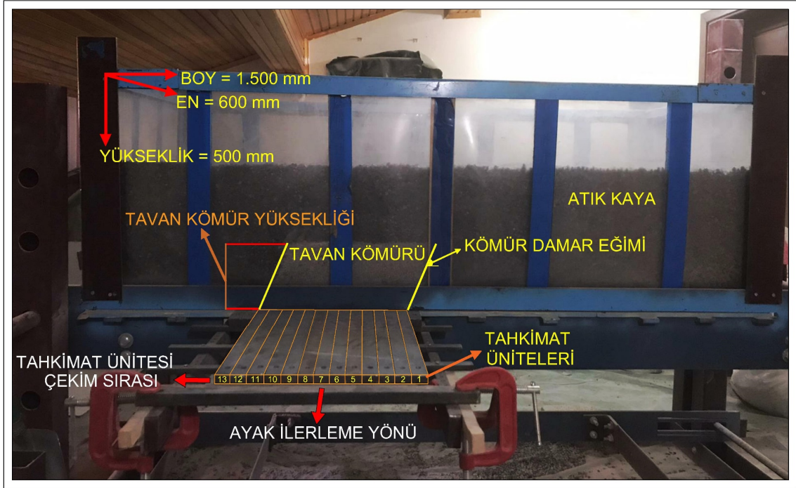
Şekil 3.2. Fiziksel modelin imalatı yapıldıktan sonraki test öncesi genel görüntüsü.
