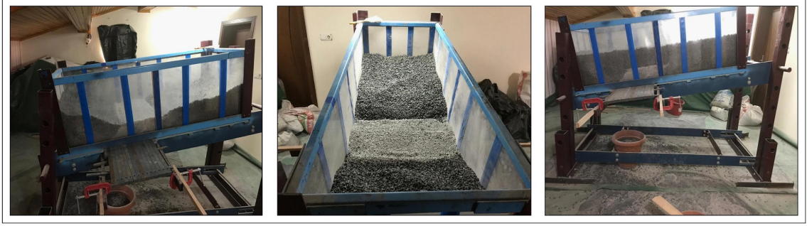
Şekil 3.5. Fiziksel modelin tavan kömürü ve atık kaya ile doldurulması.
