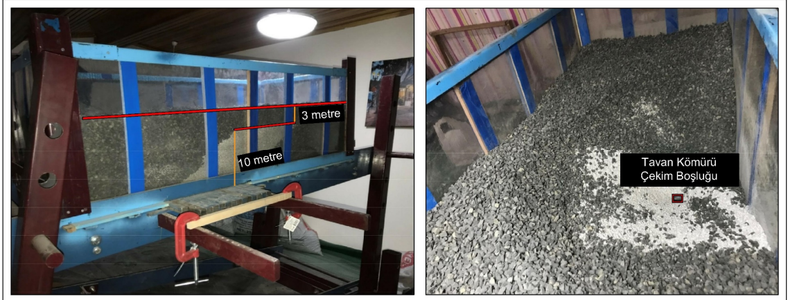
Şekil 6.1. Düşük tavan taşı yüksekliğinden kaynaklanan hatalı fiziksel model testi.
