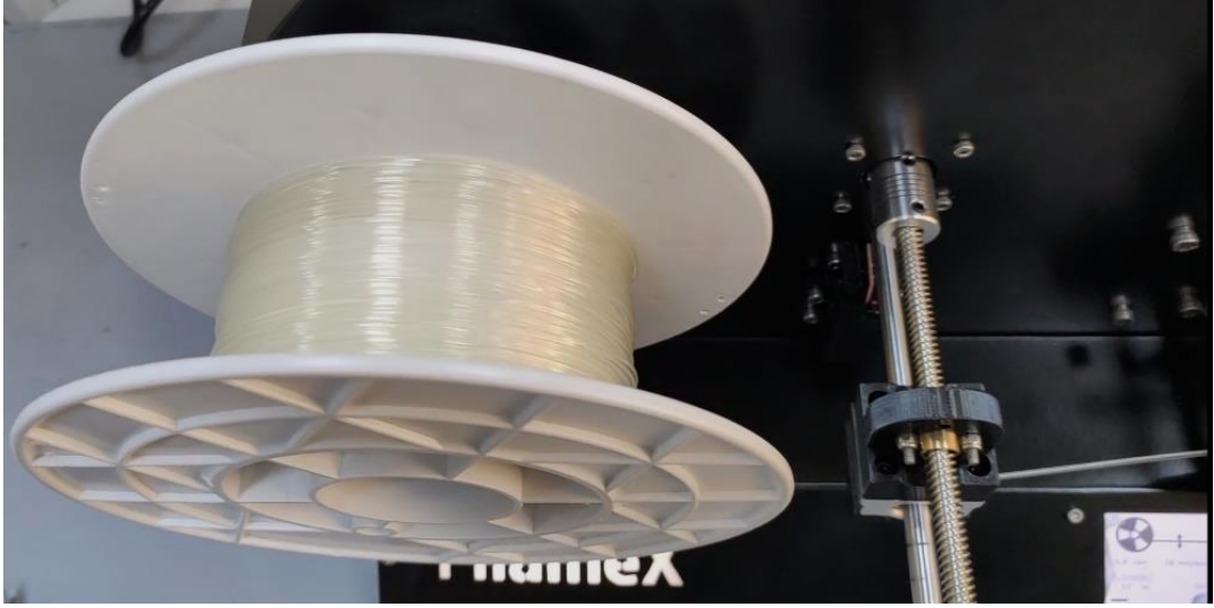
Şekil 5.7. Üretilen filamentin makaraya sarılması.
