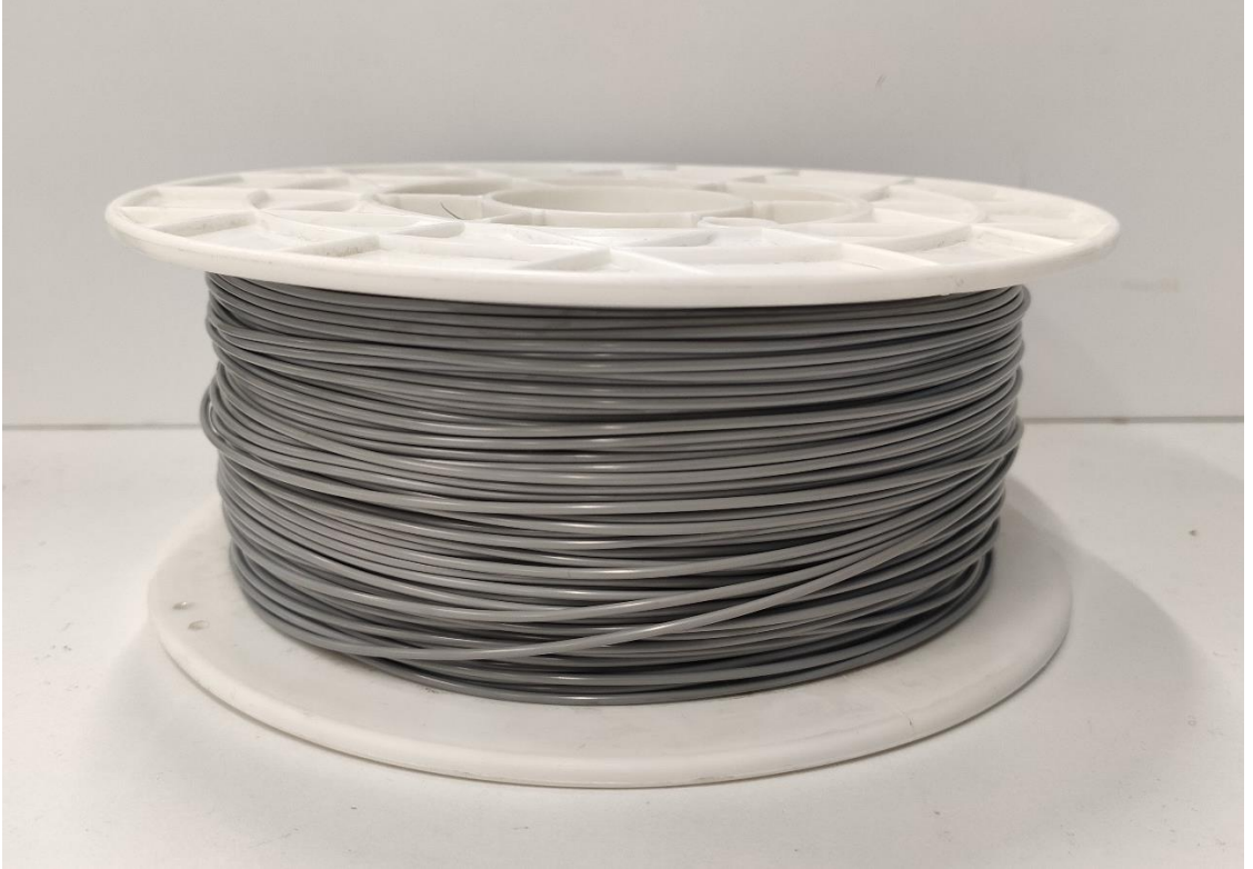
Şekil 5.11. Gümüş gri renkte üretilmiş PLA filament.
