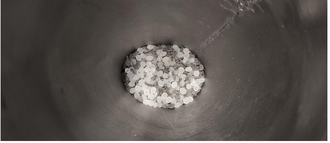
Şekil 5.10. Besleme haznesine eklenen PLA ve renk pigmenti karışımı.
