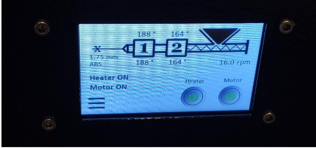
Şekil 5.16. Katkılı filament için ısı değerleri.
