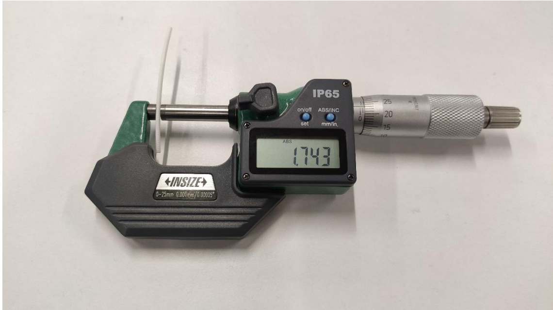
Şekil 5.6. Mikrometre ile filament çap ölçümü.
