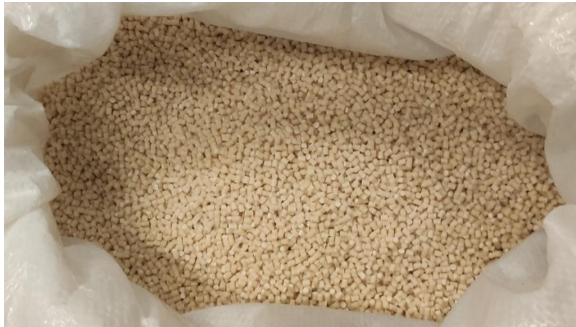
Şekil 5.15. Zeytin çekirdeği katkıli ABS granüller.
