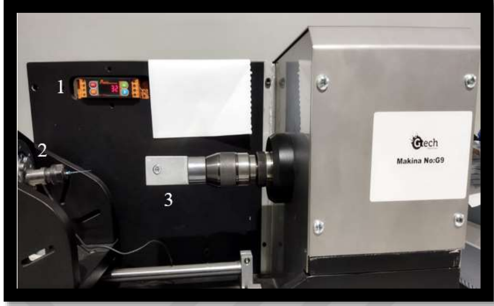
Şekil 12: Burulma Direnci Test Cihazı (Scope Endodontic System, Tork Test Cihazı); 1: Tork gösterge ekranı, 2: Eğenin şaft kısmını sabitleme bölgesi 3:Eğenin 3mm'lik uç kısmını sabitleme bölgesi.
