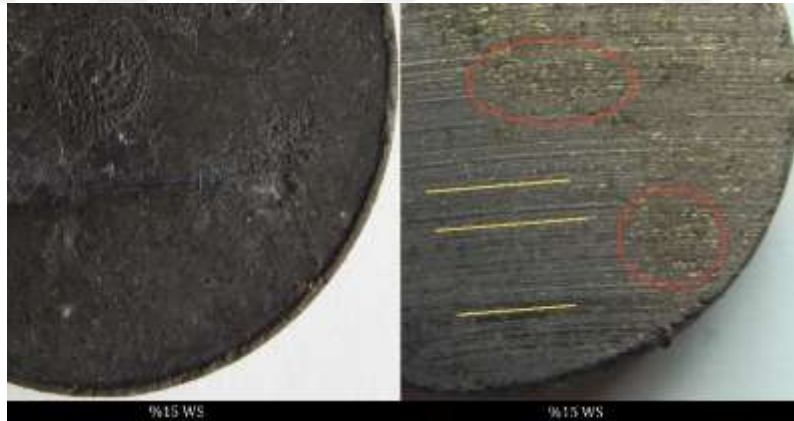
Şekil 4.45. Ağırlıkça %15 WS 2 içeren numunenin test öncesi ve test sonrası optik mikroskop görüntüleri
