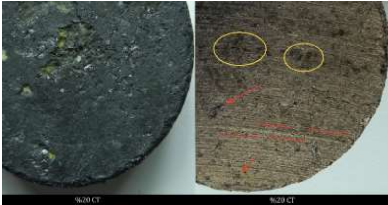
Şekil 4.41. Ağırlıkça %20 TG içeren numunenin test öncesi ve test sonrası optik mikroskop görüntüleri
