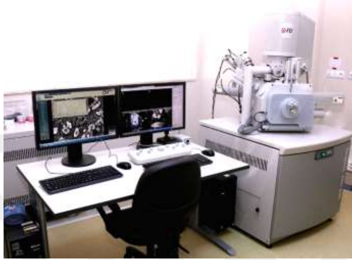
Şekil 3.8. FEI markalı Quanta 650 Field Emission SEM model taramalı elektron mikroskobu
