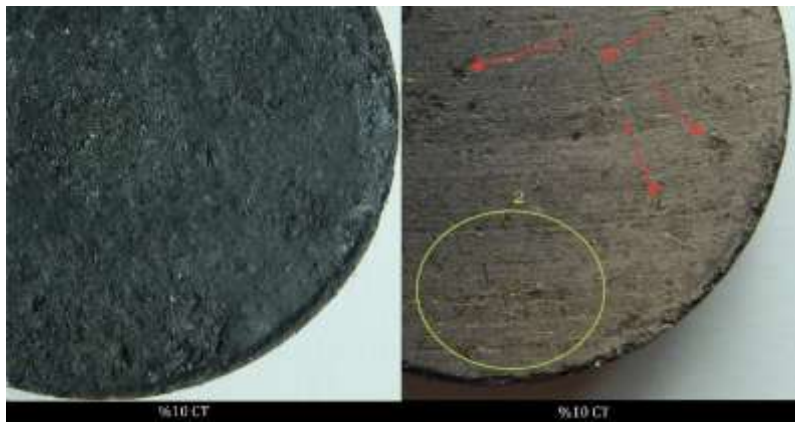
Şekil 4.37. Ağırlıkça %10 TG içeren numunenin test öncesi ve test sonrası optik mikroskop görüntüleri
