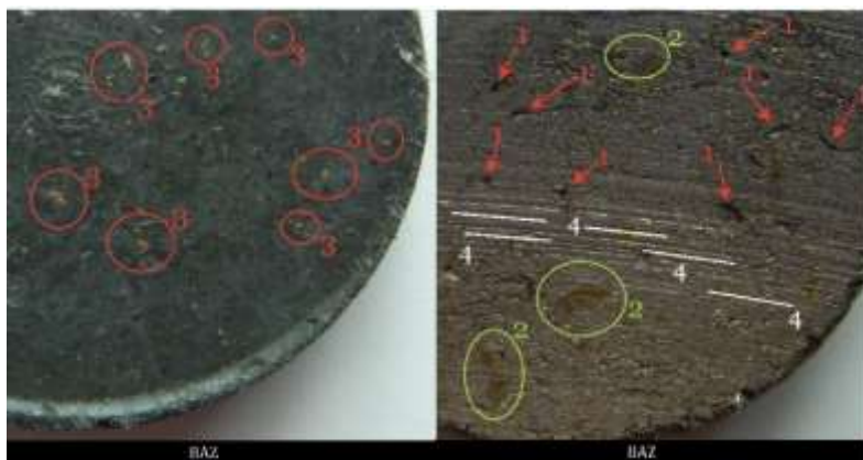
Şekil 4.29. Ağırlıkça %15 bakır içeren baz numunenin test öncesi ve test sonrası optik mikroskop görüntüleri
