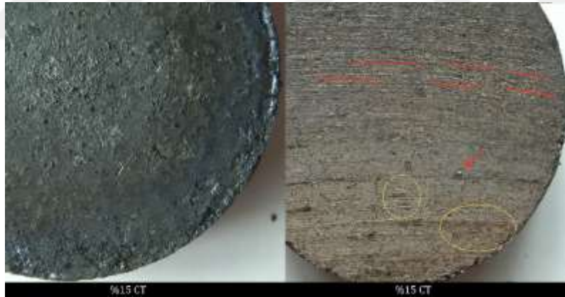
Şekil 4.39. Ağırlıkça %15 TG içeren numunenin test öncesi ve test sonrası optik mikroskop görüntüleri
