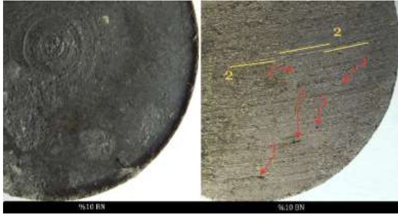
Şekil 4.31. Ağırlıkça %10 h-BN içeren numunenin test öncesi ve test sonrası optik mikroskop görüntüleri
