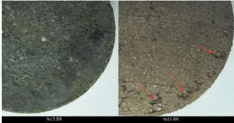
Şekil 4.33. Ağırlıkça %15 h-BN içeren numunenin test öncesi ve test sonrası optik mikroskop görüntüleri
