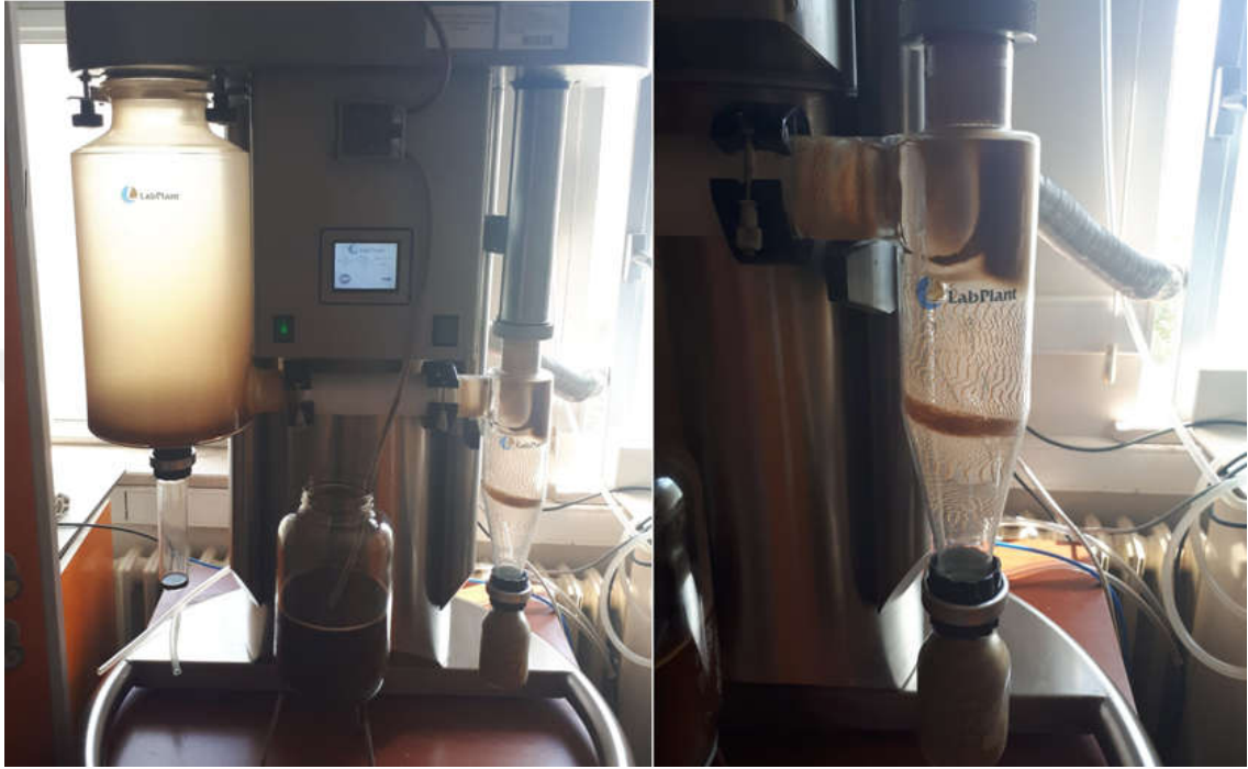
Şekil 3. Çay örneklerinin spray kurutucu ile kurutma işlemi
