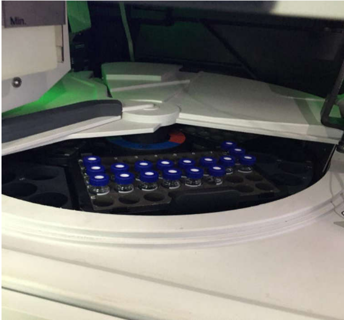
Şekil 11. Örnek viallerinin HPLC cihazına yerleştirilmesi
