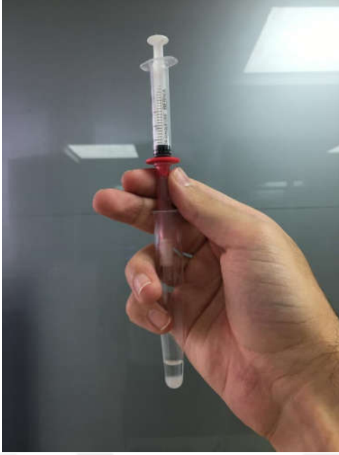
Şekil 10. Aflatoksinlerin kolondan metanol ile elue edilmesi
